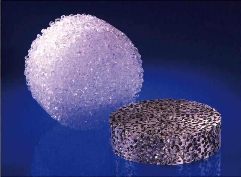
Abb. 1: Eine Platzhalterstruktur aus Polystyrol mit dem daraus entstandenen Aluminiumschwamm.
