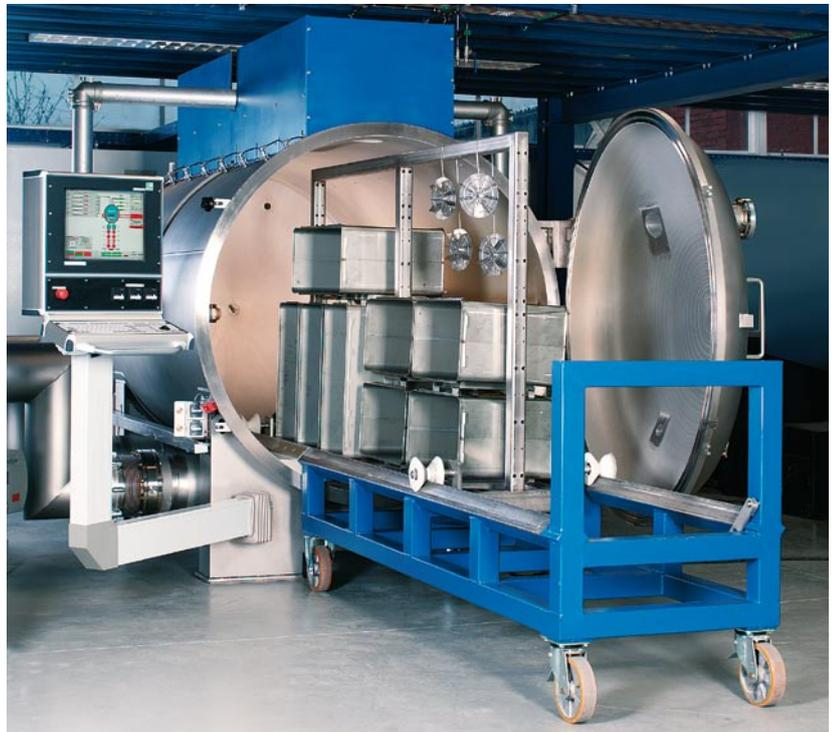
Mit dieser 5-m<sup>3</sup>-Niederdruck-Plasmaanlage lassen sich Bauteile mit der PermaCLEAN<sup>PLAS®</sup>-Beschichtung ausrüsten.
