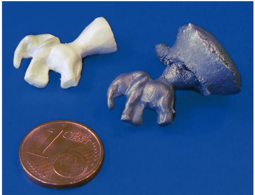
Abb. 4: Demonstrator-EPS-Modell und Gussteil.
